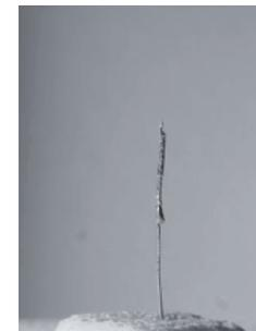
Se a superfície do fio não estiver derretida, a temperatura é demasiada reduzida.
