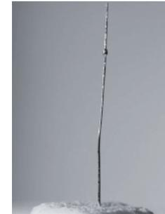
Se o fio de prata estiver quase ou totalmente fundido, a temperatura do aparelho é demasiada elevada.
