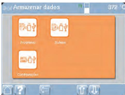
Depois da seleção, o armazenamento de dados no dispositivo USB é iniciado e surge uma indicação.
